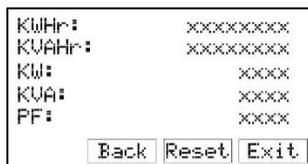
**Imagen 13.2: Pantalla para potencia y energía (si se cuenta con un módulo VDM).**
