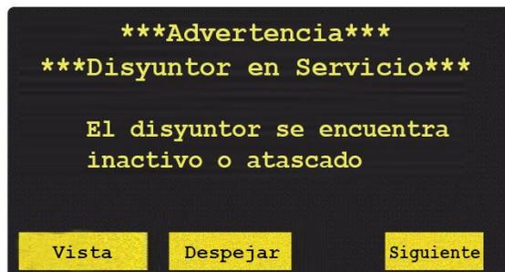
Imagen 10.1: Pantalla del mecanismo Sluggish Breaker
