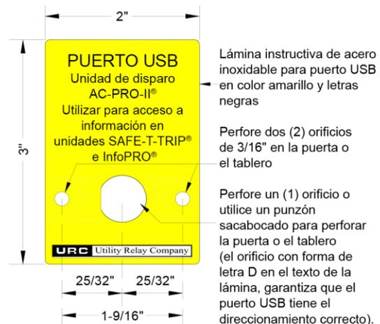
Imagen 5.6: Perforaciones en la placa de extensión para conexión USB.
