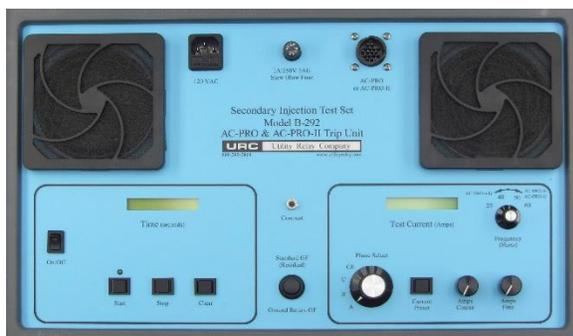
**Imagen 15.1: Equipo B-292 para pruebas de inyección secundaria.**
