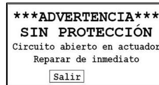
Imagen 20.2: Mensaje de circuito abierto en el actuador
